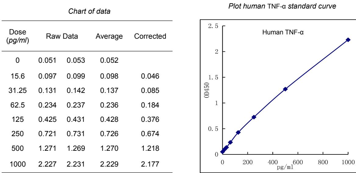
注意：本图仅供参考，应以同次试验标准品所绘标准曲线计算标本中人TNF- $\alpha$ 的含量。
