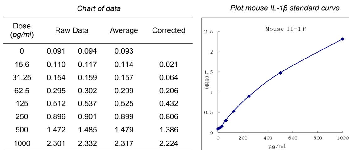
**注意:** 本图仅供参考，应以同次试验标准品所绘标准曲线计算标本中小鼠IL-1 $\beta$ 的含量。
